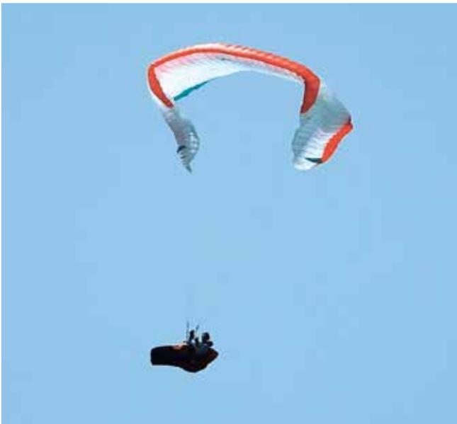
Bei gestreckten Leistungsflügeln können die vermeintlich einfach zu fliegenden grossen Ohren plötzlich hochkomplex werden, wenn man liegend im Beinsack bleibt. Une aile haute performance à l'allongement important peut soudain rendre très complexe la figure supposément simple des grandes oreilles, quand le pilote reste allongé dans son cocon.
