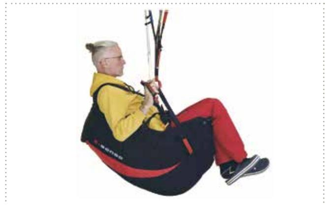
Im Gegensatz zum Liegegurtzeug weist der Pilot in der Sitzposition mit angewinkelten Beinen um alle drei Achsen ein beinahe ideales Trägheitsmoment auf. *Contrairement à une position allongée, en position assise avec les jambes repliées, un pilote bénéficie d'une répartition quasiment idéale de l'inertie autour des trois axes.*
