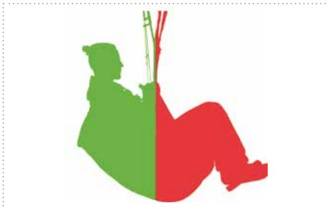
Das Sitzgurtzeug besitzt quer angeströmt eine aerodynamisch ausgewogene Verteilung (grüne zu roter Fläche) an Querschnittsfläche. Une sellette position assise frappée par un écoulement transversal de l'air bénéficie d'une répartition aérodynamique équilibrée (surface verte à rouge) de la surface de section.
