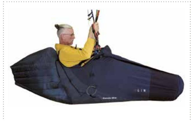
Das Trägheitsmoment um die Hochachse ist bei gestreckten Beinen markant höher und würde die Twistgefahr bei einer Kappenstörung deutlich steigern. *Jambes allongées, l'inertie autour de l'axe vertical s'avère bien plus élevée et augmente sensiblement le risque de twist en cas de dysfonctionnement de l'aile.*
